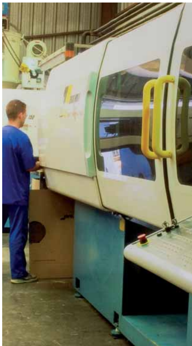
MÁQUINA DE INYECCIÓN 400 Tns.
